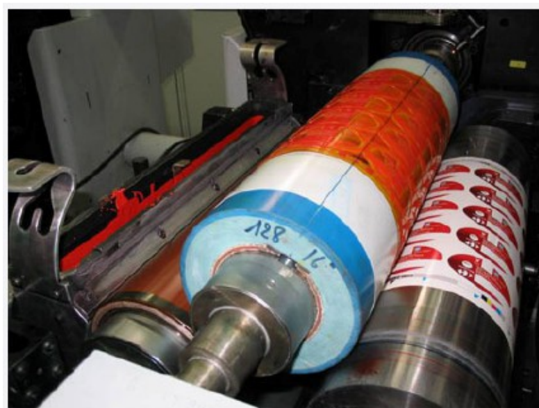
Фото 4: формная гильза в печатной машине
