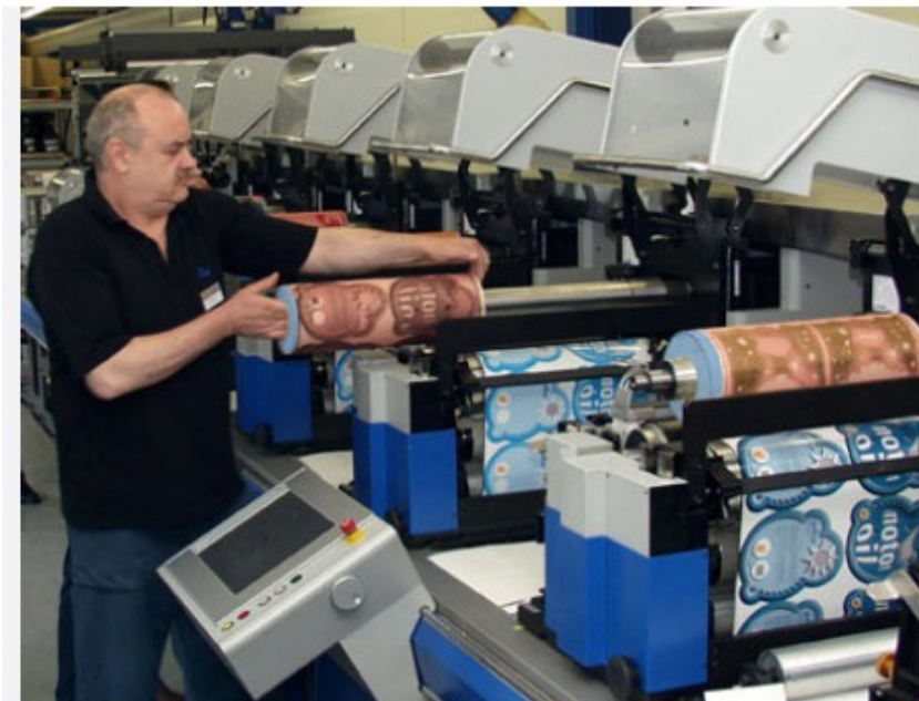
Фото 1: смена гильз на ускоренной флексографской печатной машине Gallus
