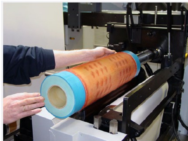
Фото 3: различную длину форматов можно реализовать с помощью подходящей толщины стенок гильз
