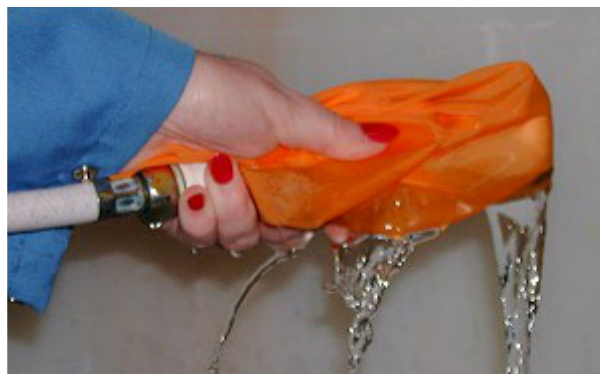
Рис. 5 Для проверки чистоты воды можно использовать сетку.
