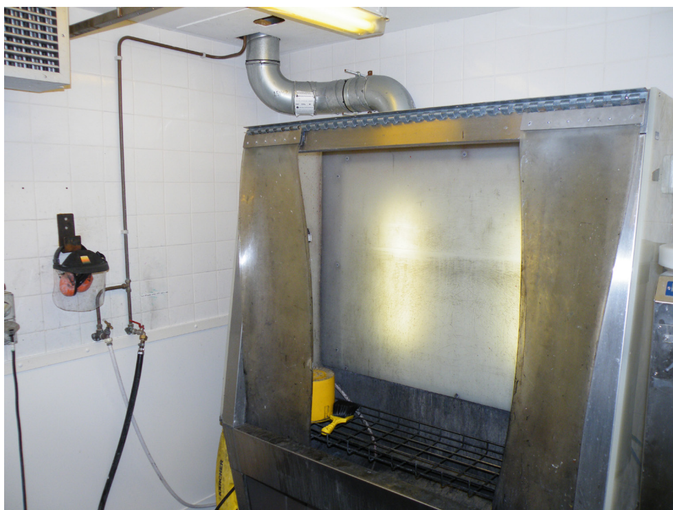
Рис. 2 Ванна для очистки ТДФ с встроенной вытяжкой
