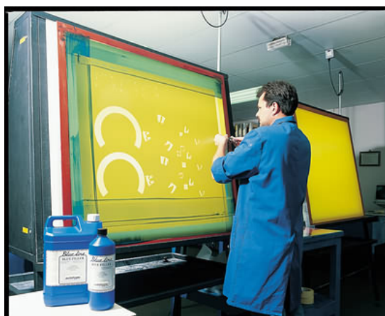
Рис.12 Подготовка (ретуширование) трафаретов перед печатью.
